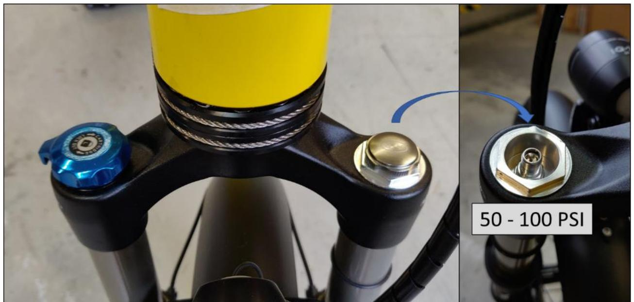
Das Ventil zur Druckregulierung befindet sich unter der linken Kappe auf der Gabelbrücke. Diese Kappe wird durch Drehen gegen den Uhrzeigersinn entfernt, anschließend wird über das Schrader-Ventil die Pumpe zur Regulierung angeschlossen (siehe Bild oben).
