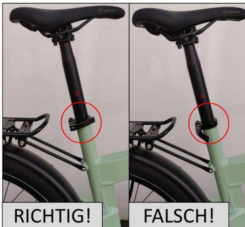
Die Spannkraft reicht aus, wenn sich der Hebel beim Schließen ab der Mitte schwer bewegen lässt und das letzte Stück mit dem Handballen gedrückt werden muss. Wenn dies nicht der Fall ist kann die Spannkraft, wie oben beim Schnellspanner am Vorderrad beschrieben, angepasst werden.
