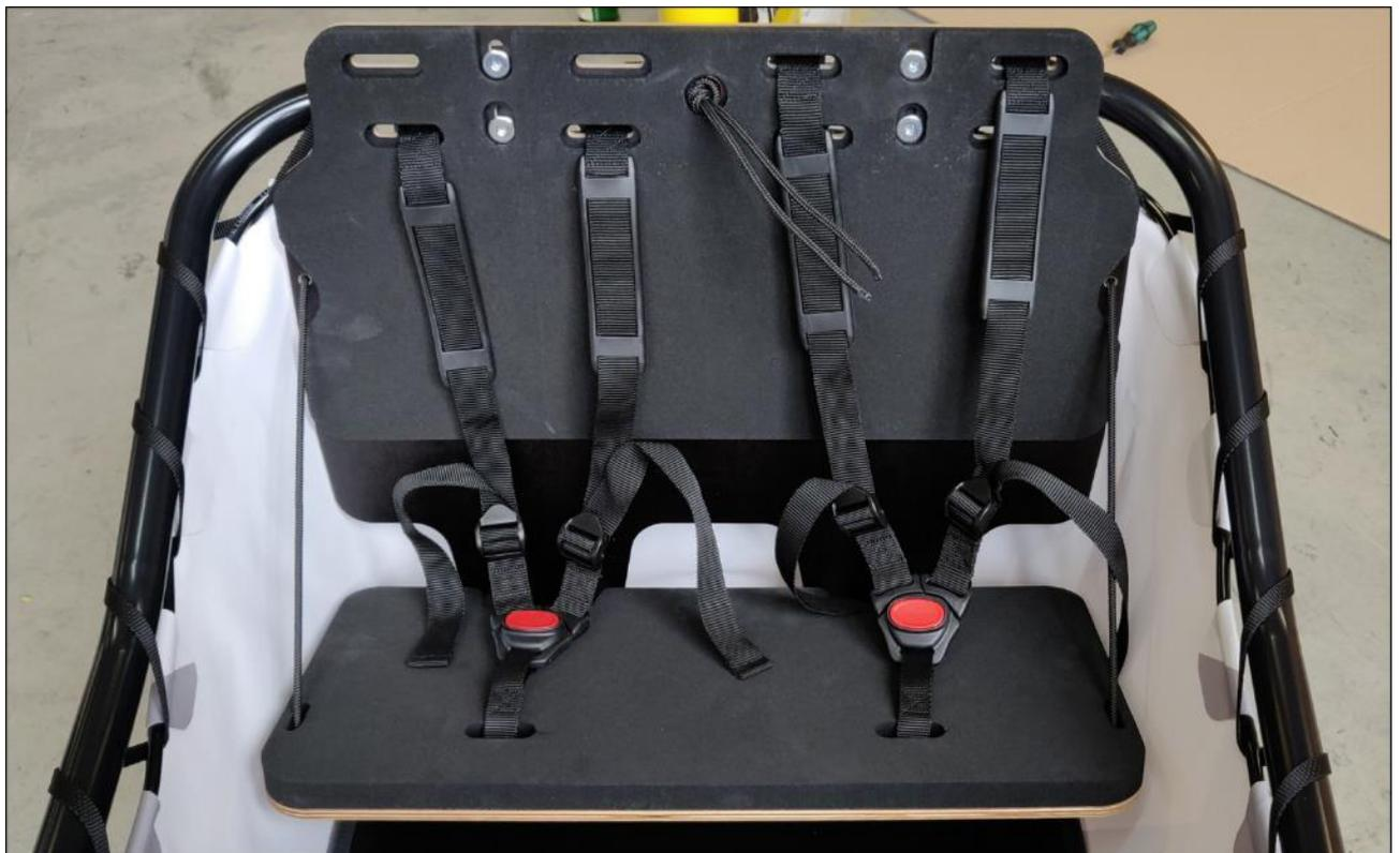
In der oberen Position ergibt sich automatisch eine etwas höhere Schulterbreite. Die Gurtlänge kann an den oberen Enden des Dreipunktgurtes im montierten Zustand verstellt werden. Durch diese Funktion kann die Verschlussschnalle im losen Zustand geschlossen und anschließend der Gurt gestrafft werden.
