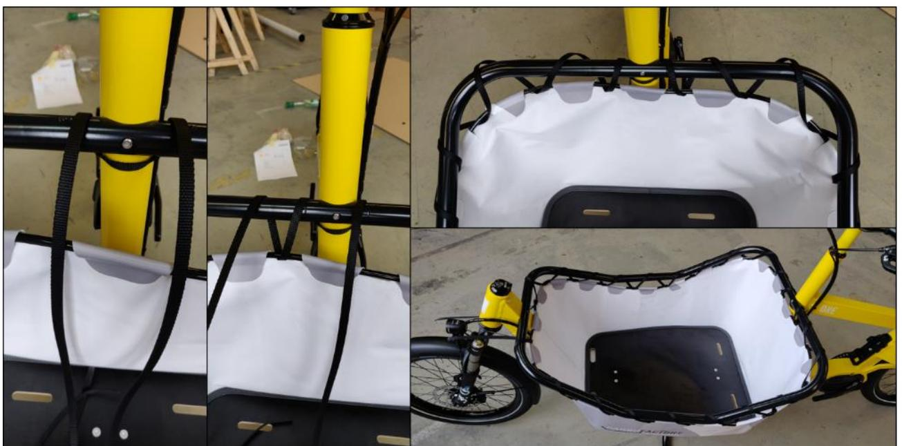
Wenn das Gurtband eingefädelt ist kann es mit dem beiliegenden Dreisteg verschlossen werden.
