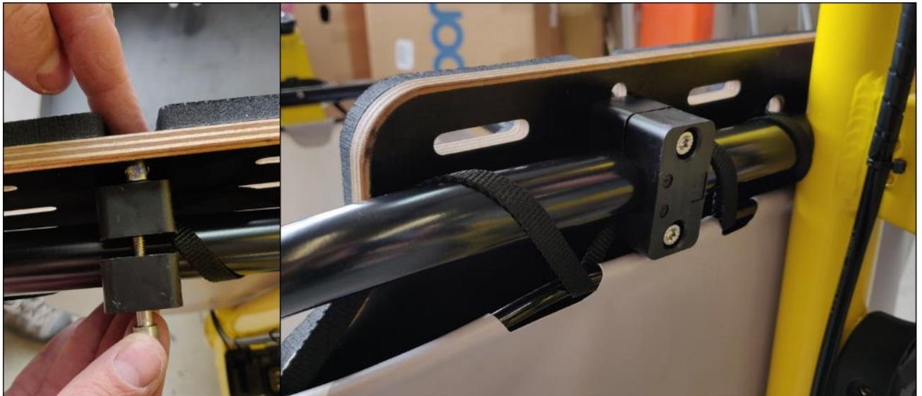
Im vorderen Bereich des Korbs wird nun noch die Fußplatte montiert:
